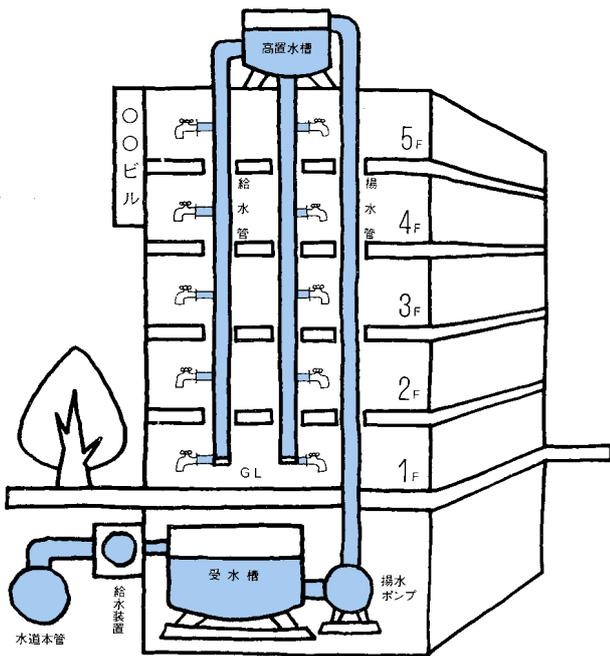
受水槽をもつ水道のうち、受水槽の容量が 10 m<sup>3</sup>を超えるものは、水道法で「簡易専用水道」とよばれ、①設置者が衛生的に管理すること、②定期的に検査を受けること、が義務付けられています。
