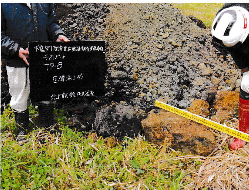
TP-8 礫混り土砂主体。 長径 70 cm大の大礫混在。
