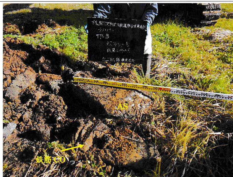
TP-3 長径 90 cm大のアスファルト片および鉄筋コンクリート片散在。
