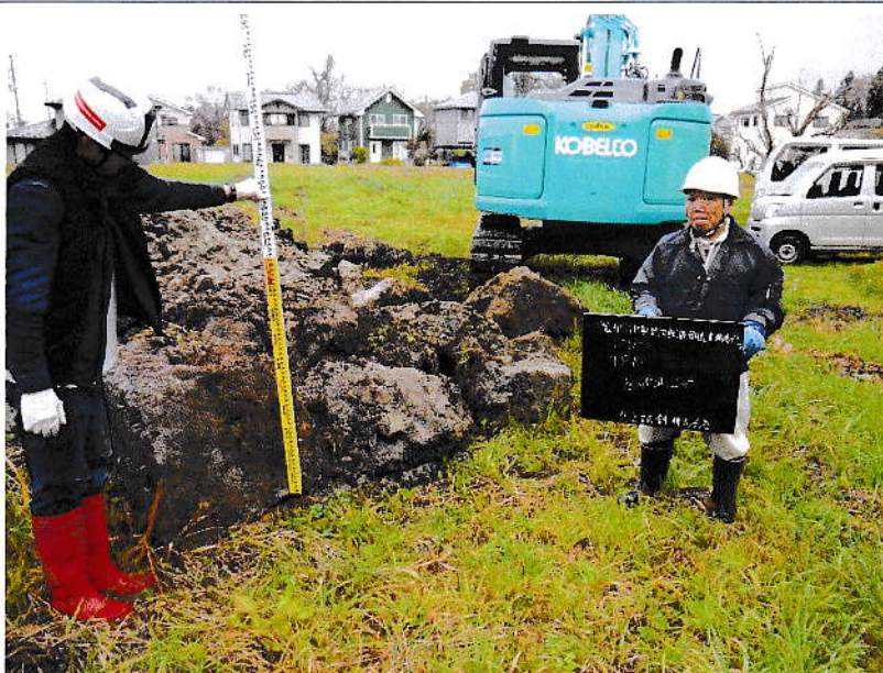
TP-10 長径 30 cm~90 cm大の 大礫多数混在。
