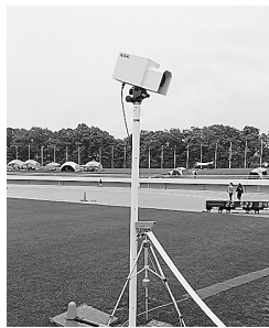
選手の着順判定に使用する写真判定装置
