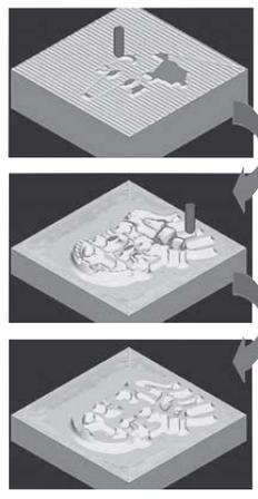
3次元CAMで金型製造を自動化
