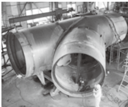
秋田県北秋田市の森吉山ダムに使用されている水圧鉄管分岐管
