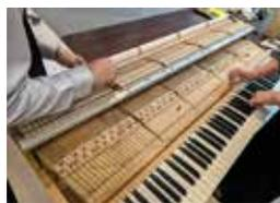
←鍵盤を押すとハンマーが弦を打つというピアノの仕組み部分を、本体から外した状況です。
