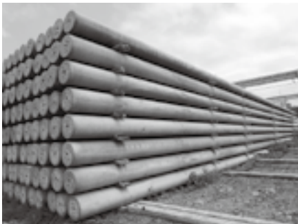
製作工程後のコンクリートポール。屋外で2週間保管し、耐久性を高めた後に出荷されます
