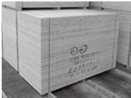
出荷前の構造用合板。合板の上面には国産材の認証スタンプが一枚一枚押されています
